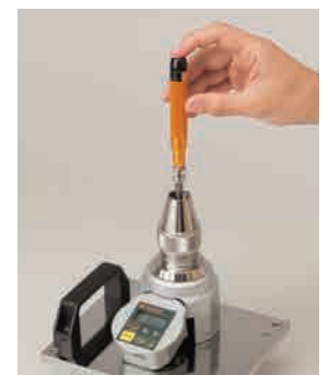
微小トルクドライバ BMRD の BTGE によるトルクチェック例 (オプションの BTGE 測定台を使用)
