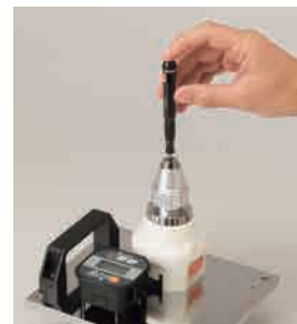
微小トルクドライバ AMRD の ATGE によるトルクチェック例 (オプションの ATGE 測定台を使用)
