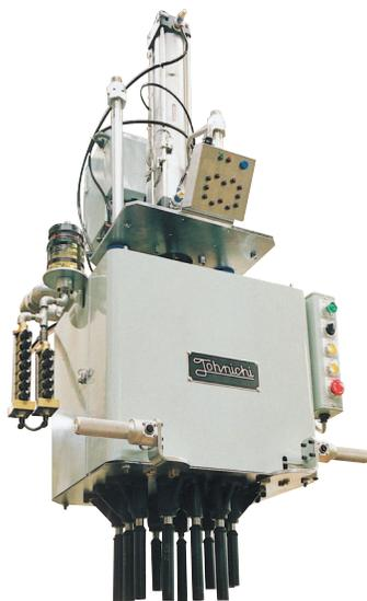
ねじの締付け作業で最も多い締め忘れミスを未然に防ぐシステムです。マイクロスイッチの働きでランプを点灯させたり、ブザーを鳴らして締付け完了を直接確認します。
