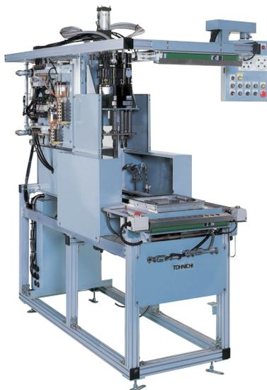
ワークを手前にセットすると自動で奥へ移動し、締付けを行います。上面と側面の締付けを自動で行い終了するとランプを点灯させワークを元の位置に戻します。
