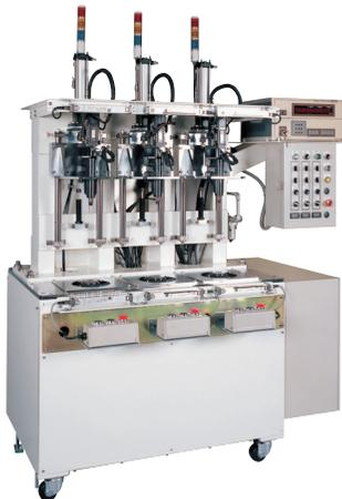
各軸が個別に連続締付けを行いトルクコントローラのトルク制御により、設定されたトルク値で自動停止します。同時に、締付けトルクをチェックし自動で合否判定を行います。また、仮締め制御やワークの機種選択、組み込みミスの異常を検知します。測定データはPCに転送しデータ処理を行うことができます。
