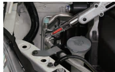
自動車配管締め付けでの使用例 (ソケットでは配管締め付けは難しい)
