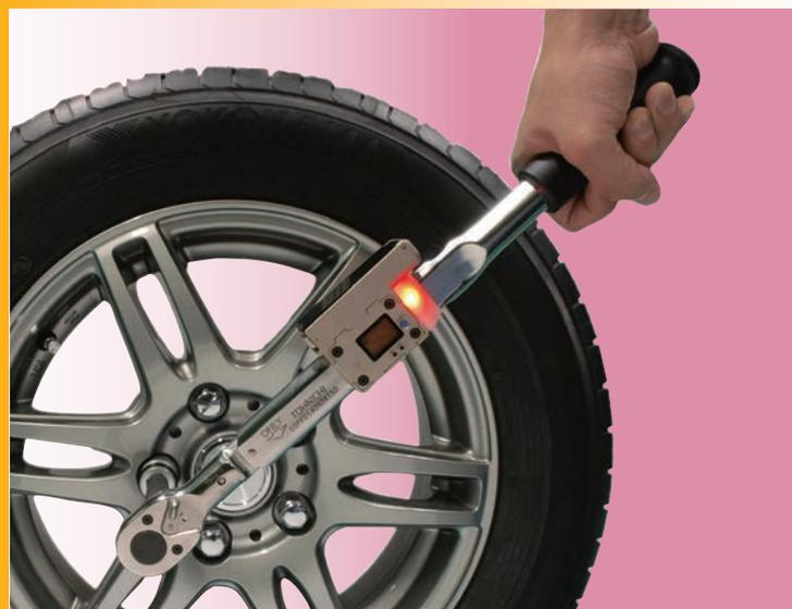
紧固一个已按所需扭矩紧固的相同螺栓时, LED 灯将亮红色。
