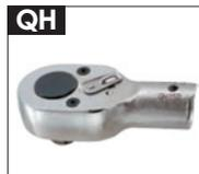
ヘッド交換式トルクレンチならラチェットも接続可能。ラチェットヘッドQH8Dはソケットを取り付けて、振り角が少ない場所でも効率的な締め作業が行えます。角ドライブは□6.35です。
