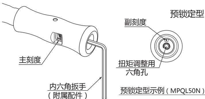
**预锁定型**：扭力扳手上有机矩刻度，但变更设定扭矩时需要工具。紧固作业中不易变更设定扭矩，可防范人为失误，且扭矩调整不需要检测仪，该扭力扳手兼顾了预置型和单功能型的优点。
