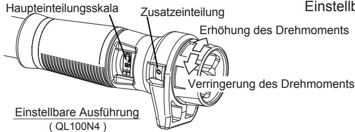
**Einstellbar :** Der einstellbare Drehmomentschlüssel haben Mikrometerskala und benötigt keine weiteren Werkzeuge für die Drehmomenteinstellung. Das Zieldrehmoment wird per Hand eingestellt.
