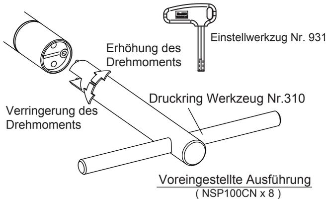
**Voreingestellt :** Voreingestellte Drehmomentschlüssel haben keine Mikrometerskala und benötigen passende Werkzeuge und Drehmomentprüfgeräte für die Drehmomenteinstellung. Diese Art von Drehmomentschlüssel ist vor allem für Verschraubungen in Fertigungslinien geeignet.
