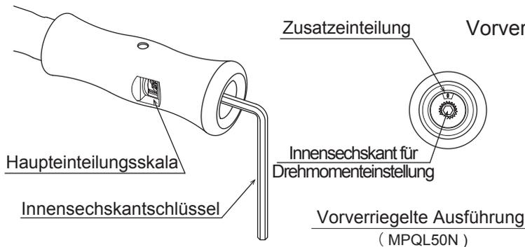
**Vorverriegelt :** Drehmomentschlüssel mit Vorverriegelung haben Mikrometerskala. Für die Drehmomenteinstellung wird ein Innensechskantschlüssel benötigt. Dadurch wird eine versehentliche Änderung des Zieldrehmoments verhindert.
